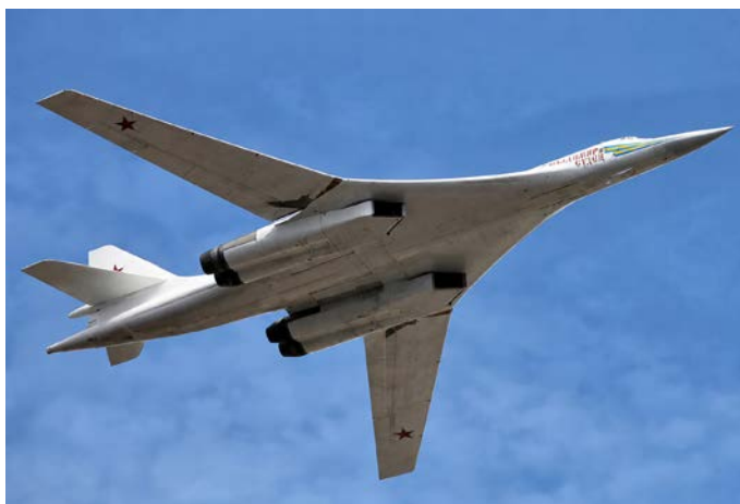
Figure 12 Le Tu-160 avec les ailes à 65 degrés maximum. Rayon d'action subsonique ultra-long typique du Tu-160M2 à basse altitude avec 2 x 6 missiles de croisière Kh-101 entièrement en interne dans les soutes à armement : 1740 NM / 3230 km) © Vitaly V. Kuzmin, CC BY-SA 4.0
