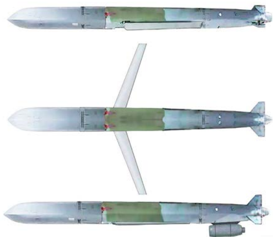
Figure 10 : Missile de croisière russe Kh-101, tiré à partir de bombardiers Tu-95 ou Tu-160. Noter les formes permettant une furtivité limitée. © Vslv, CC
