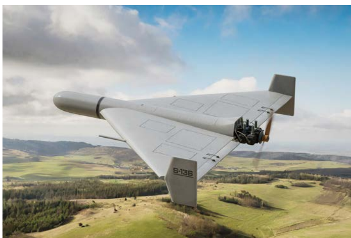
Figure 1 : Shahed 136 : envergure 2,5 m ; longueur 3,5 m ; masse 180 kg ; charge explosive 40 kg ; autonomie 1 700 km ; prix 20 000 $. © Adobe stock
