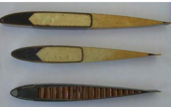
Figure 138 - Coupe des pales Écureuil et Gazelle
