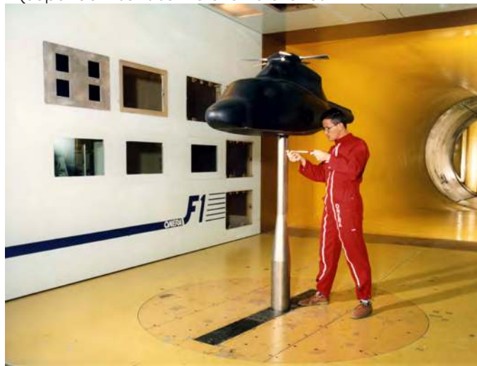
Figure 190 - Maquette DGV 200 dans la soufflerie pressurisée F1 du Fauga
