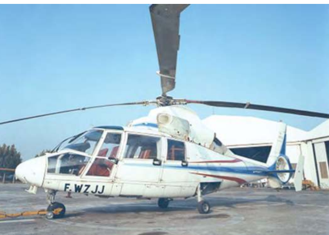
Figure 184 - Dauphin 365 N testant les extrémités paraboliques en flèche
