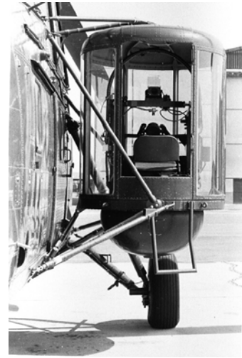
Figure 67 - Tourelle canon sur H-34 (photo CEV)
