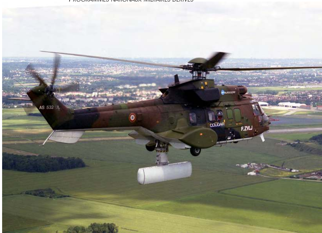
Figure 180 - Hélicoptère HORIZON antenne déployée (photo CEV)
