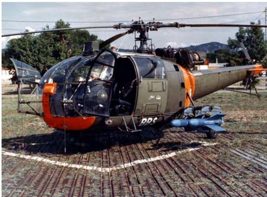
Figure 41 - SA 316 B équipée du « système » AS 12 (maquettage)
