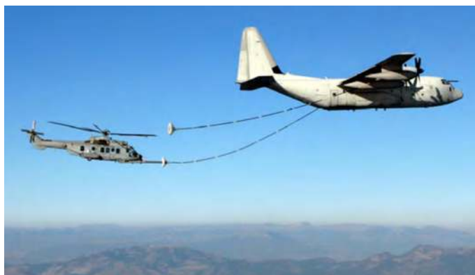
Figure 126 - EC 725 AP ravitaillé à partir de l'avion de transport Hercules KC 130 J
