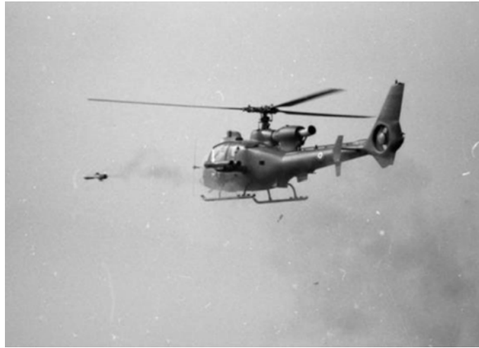
Figure 88 - Tir d'un missile HOT de la Gazelle n°1458 (photo CEV)
