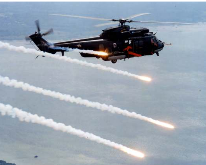
Figure 168 - Super Puma AS 532 UL équipé de lance-leurres (photo CEV)
