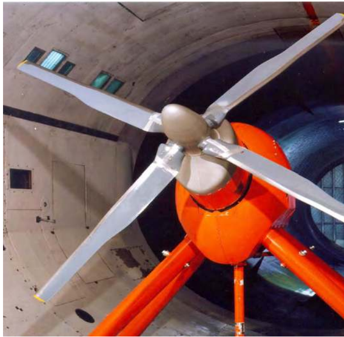
Figure 198 - Rotor de convertible RC4 dans la soufflerie S1 de Modane
