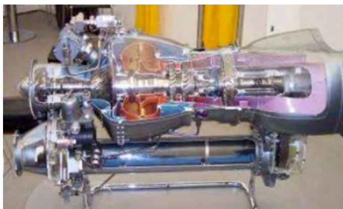
Figure 137 - Écorché du moteur Arriel 1B
