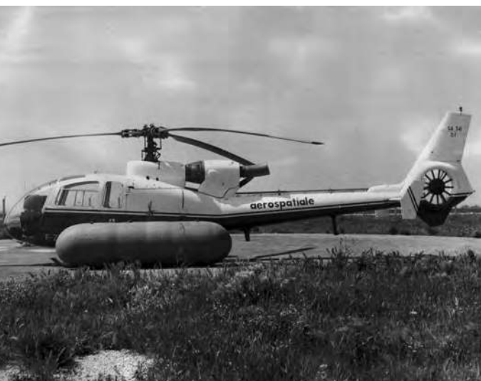
Figure 82 - SA 341 01 avec flottabilité de secours gonflée (photo CEV)
