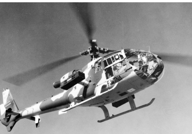
Figure 87 - Gazelle SA 342 L n°1185 avec panier lance-roquettes (essais CEV pour version export)(photo CEV)
