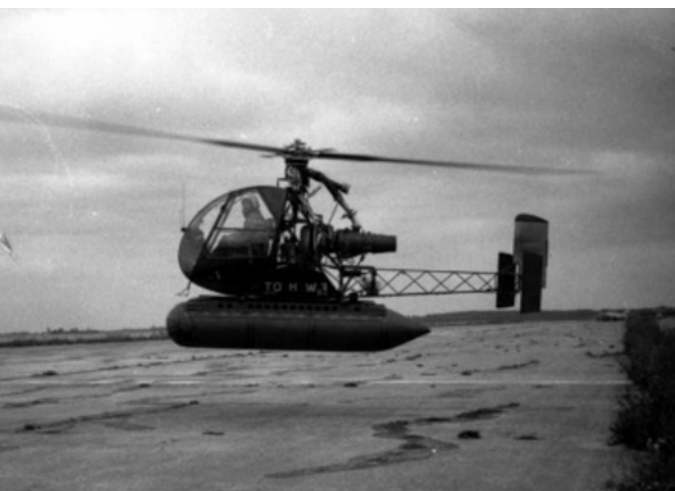
Figure 77 - Djinn avec flottabilité en essai au CEV (photo CEV)
