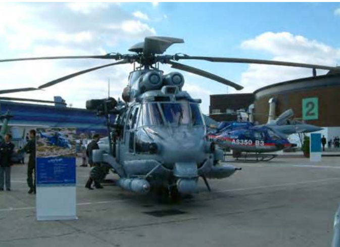
Figure 170 - EC 725 Caracal au Bourget en 2005 avec sa perche de ravitaillement en vol et son armement
