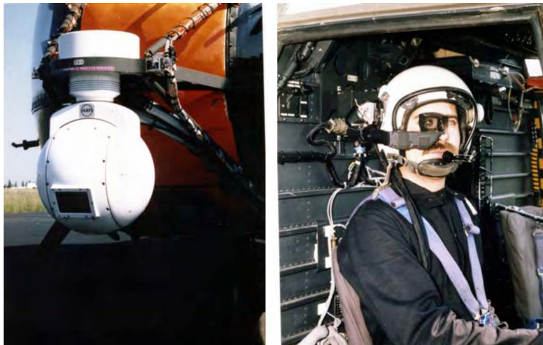
Figure 102 - Un exemple des études préparatoires : l'opération APHRODITE, expérimentation menée au CEV, sur le Puma n° 1027, du système de pilotage de nuit constitué d'une boule contenant une caméra thermique, asservie à un viseur de pilotage.
