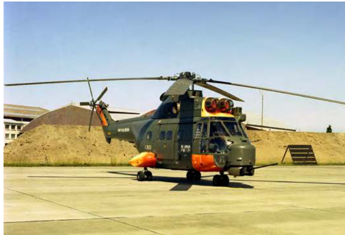
Figure 75 - Puma 04 HECTOR : appareil de servitude pour canon de 30 mm en tourelle, au profit du Tigre (photo CEV)
