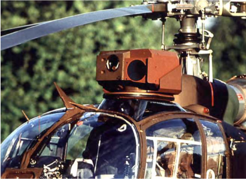
Figure 90 - Viseur jour/nuite Viviane sur Gazelle SA 342 M1 (photo MBDA)
