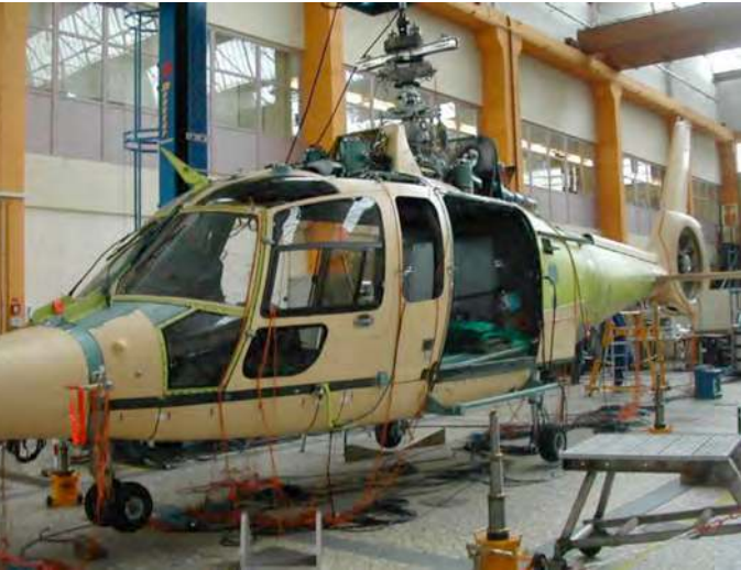
Figure 195 - Essai vibratoire au sol de l'EC 155
