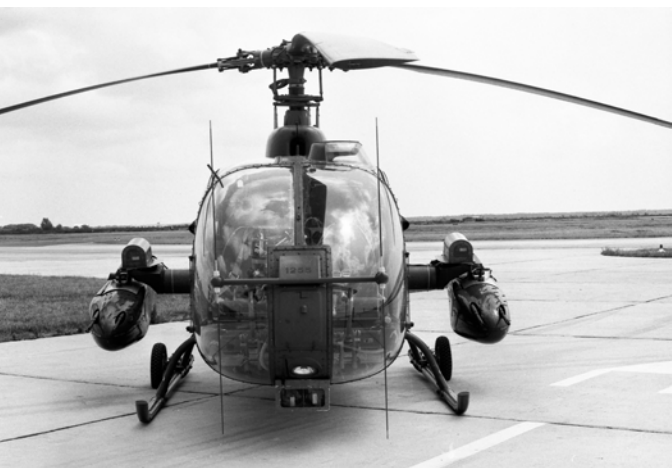
Figure 86 - Gazelle SA 341 F n°1255 Aérospatiale avec panier lance-roquettes Matra (photo CEV)
