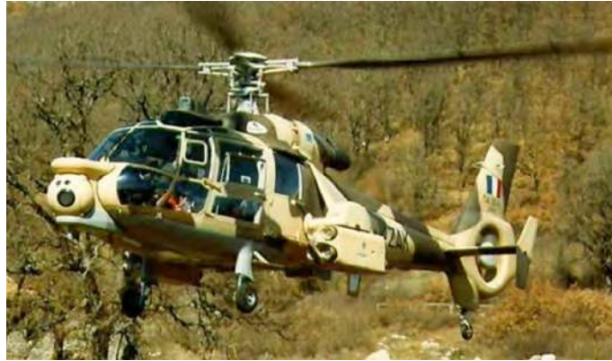
Figure 171 - Dauphin 1012 équipé du système VENUS, pour le tir du HOT de nuit
