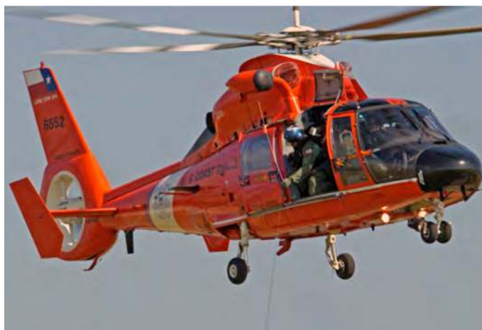
Figure 133 - SA 366 G1 de la US Coast Guard. On note le fenestron agrandi et le treuil spécifique © Photo DR/Airbus Helicopters
