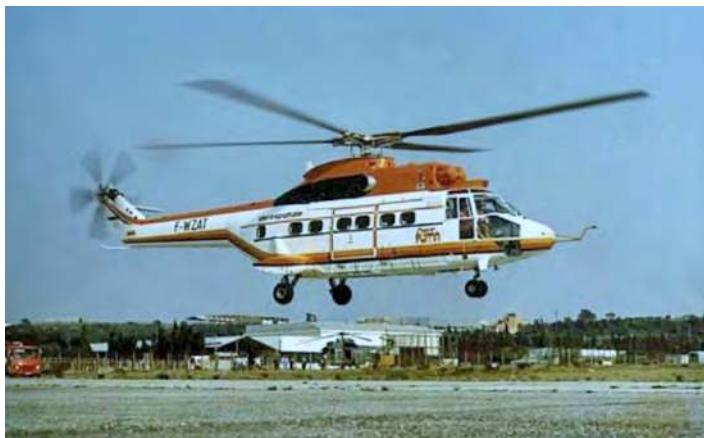
Figure 123 - Le SA 331 au cours de son premier vol. L'appareil a été profondément modifié et le nez rallongé. Remarquer la tête rotor, le train et la poutre de queue. © EC
