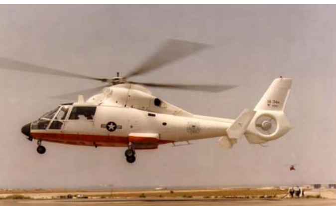
Figure 132 - Le SA 366 n°6002, équipé du fenestron de 0,90 m © Photo DR/Airbus Helicopters
