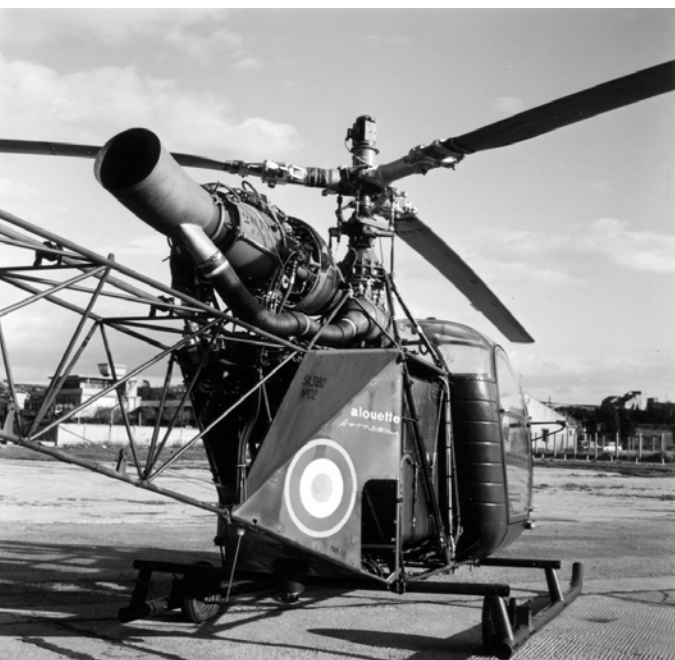
Figure 34 - Alouette II Astazou SA 3180 n°02 équipée à titre expérimental d'un moyeu MIR de Bölkow © Photo DR/Airbus Helicopters
