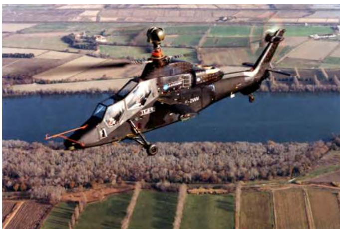
Figure 108 - Prototype n°1 destiné aux essais « véhicule » (performances, qualités de vol,...) ici en configuration HAC (avec une maquette de viseur de mât)
