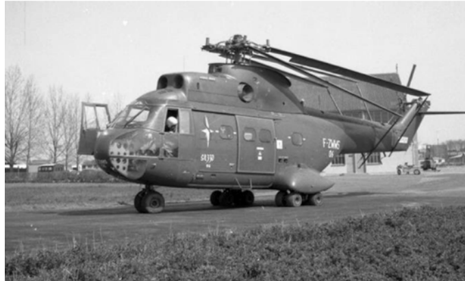
Figure 71 - Puma SA 330 n°06 avec train Dop Precimo et pales repliées (photo CEV)
