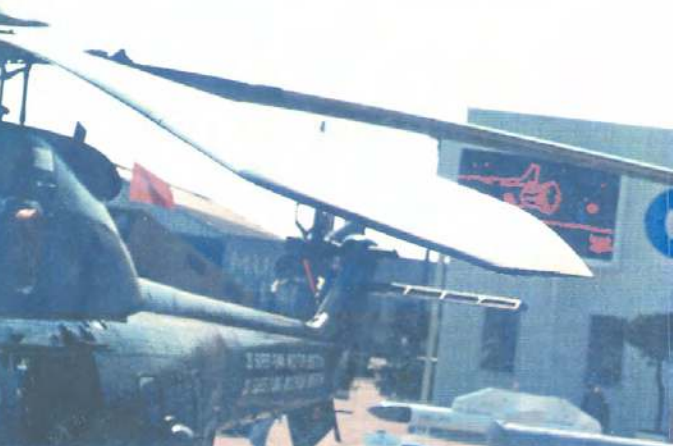
Figure 185 - Pale parabolique et avec dièdre sur Puma
