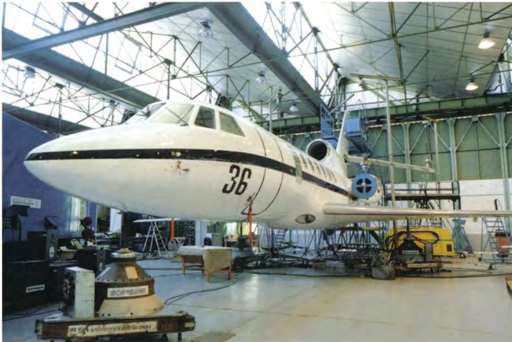
Fig. 82 Essai de vibration d'un Falcon
