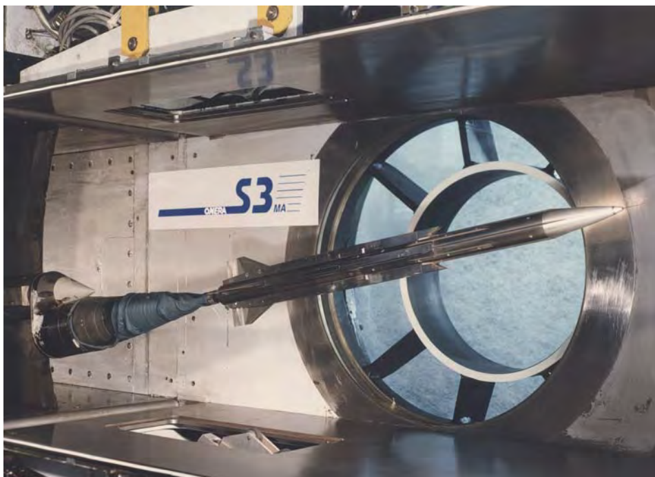
Fig. 43 Essai d'aérodynamique externe d'une maquette du missile ONERA-Matra MPSR2 (Missile probatoire à statofusée rustique 2 e génération) dans la soufflerie S3MA de Modane (1991)
