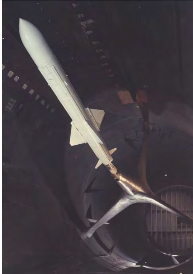
Fig. 28 Essai d'une maquette en vraie grandeur du missile Exocet MM40 dans la soufflerie S1MA de Modane (1974)
