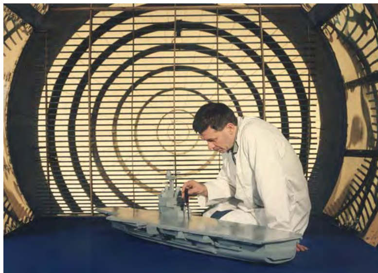
Fig. 74 Essai d'une maquette (échelle 1/50) du porte-avions Charles de Gaulle dans la soufflerie horizontale de l'IMFL. Au fond est visible la grille qui permet d'ajuster la couche limite amont
