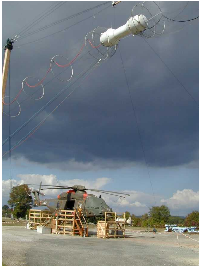
Fig. 7 Simulateur d'effets électromagnétiques
