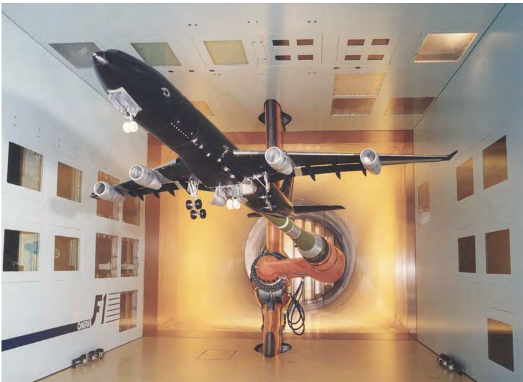
Fig. 59 Essai d'une maquette Aérospatiale d'Airbus A340 dans la soufflerie F1 du Fauga
