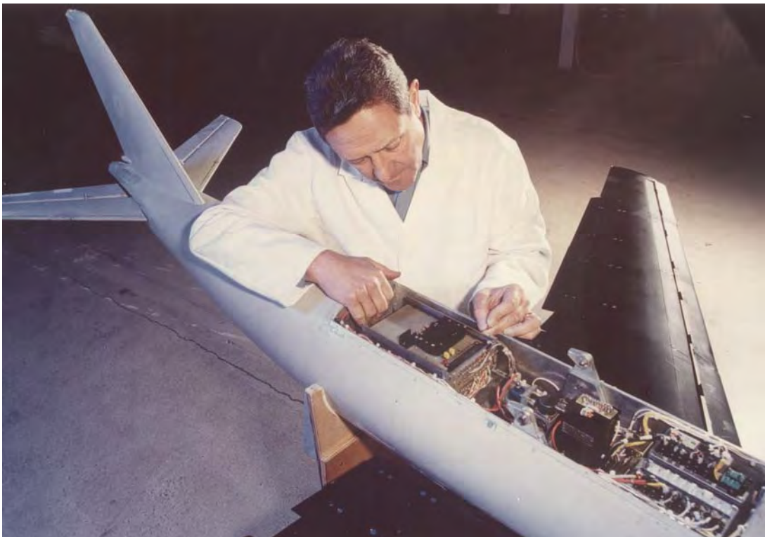
Fig. 76 Réglage et vérification de l'électronique embarquée dans une maquette d'A330 catapultée
