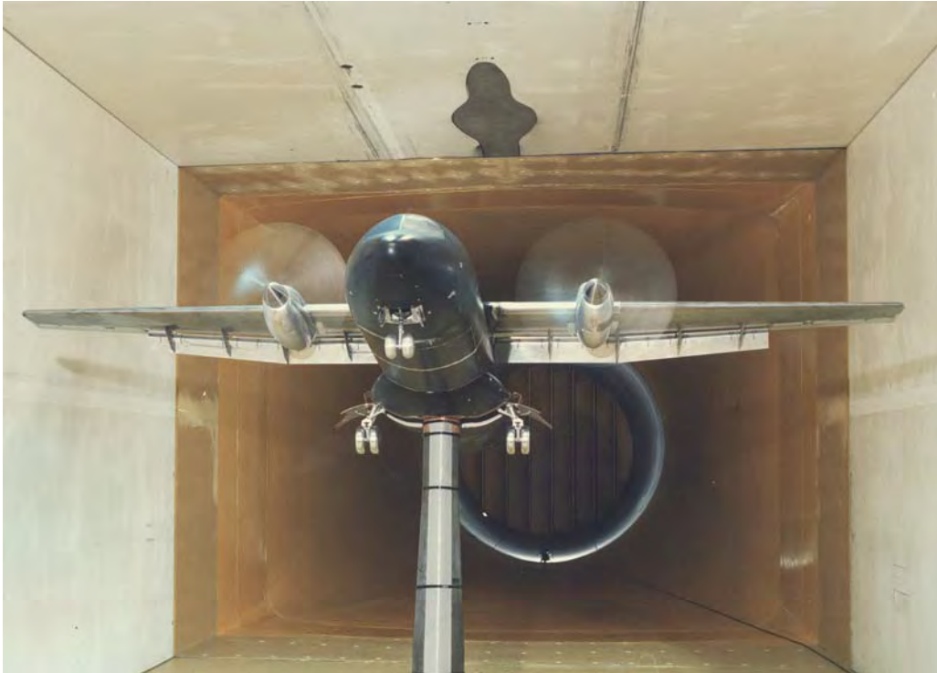
Fig. 58 Essai d'une maquette (échelle 1/8) de l'ATR 42 dans la soufflerie F1 du Fauga
