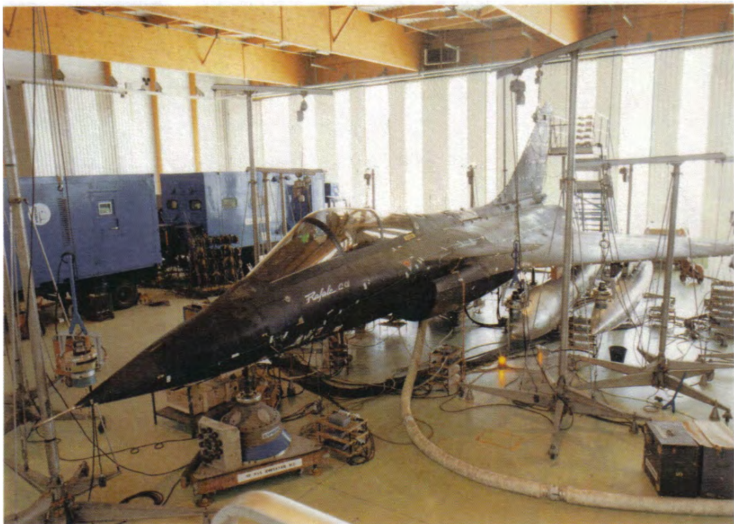
Fig. 81 Essai de vibration du Rafale
