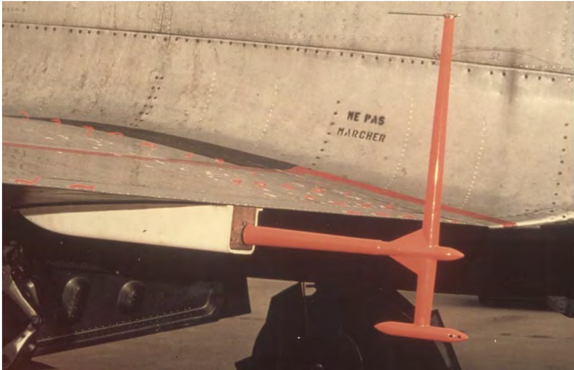
Fig. 90 Explorateur de sillage fixé à l'aile d'un T33 pour la mesure des pressions statique et dynamique
