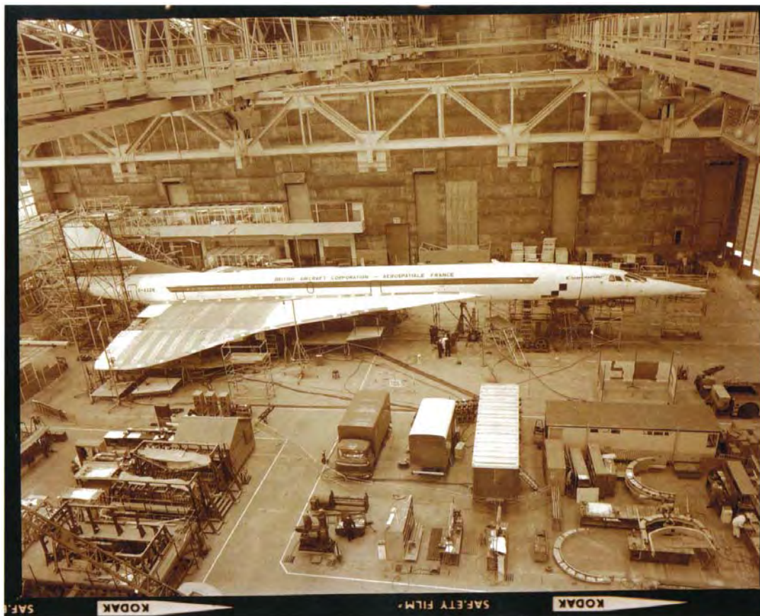
Fig. 83 Essai de vibration du Concorde (1971)
