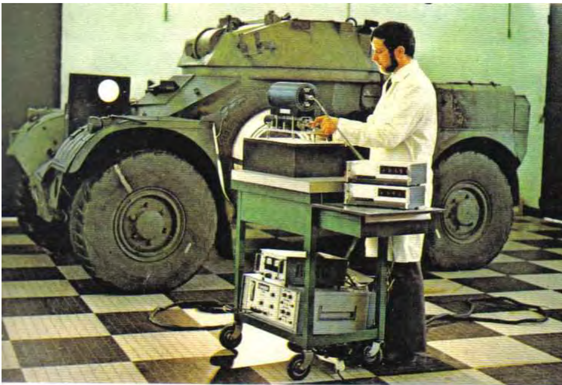
Fig. 4 Mise au point d'un appareillage de mesures accélérométriques et vélocimétriques sur un engin blindé léger, avant son départ pour le tunnel de Sauclières
