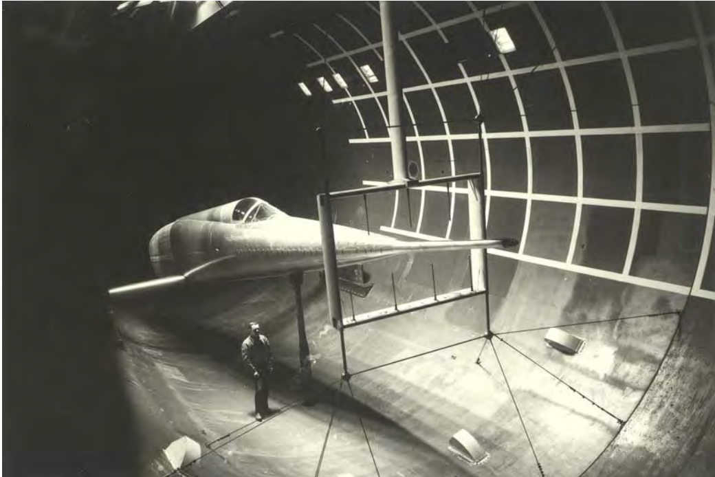
Fig. 19 Essai de visibilité à travers le pare-brise du Mirage IV par temps de pluie, dans la soufflerie S1MA de Modane (1963)
