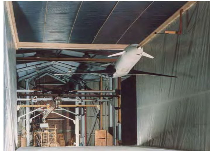
Essai d'une maquette d'avion d'affaires TGA (Très Grand Allongement) au banc B10 , avec rafales verticales (1982-1989)
