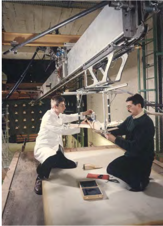
Fig. 70 Préparation d'un essai de largage sur la catapulte B5 de l'IMFL
