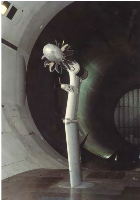
Fig. 30 Essai d'hélices contrarotatives du turboréacteur à hélices rapides (THR) de SNECMA-General Electric
