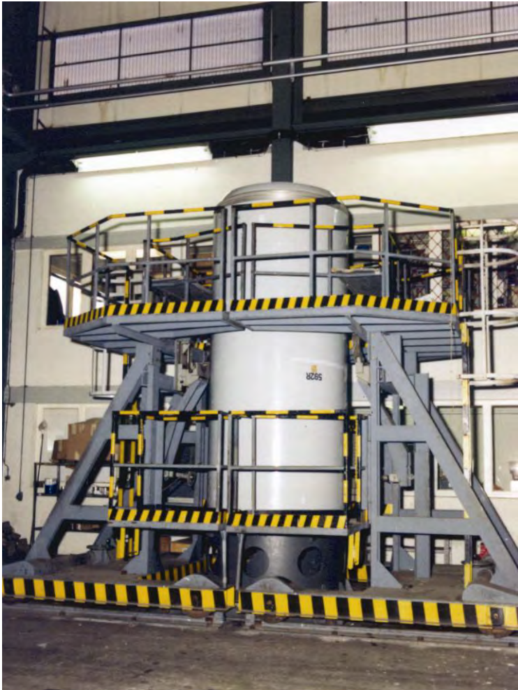
Fig. 15 1980, préparation par la SEP d'une structure de propulseur 401 du premier étage du missile M4, avant envoi à la SNPE pour chargement en propergol
