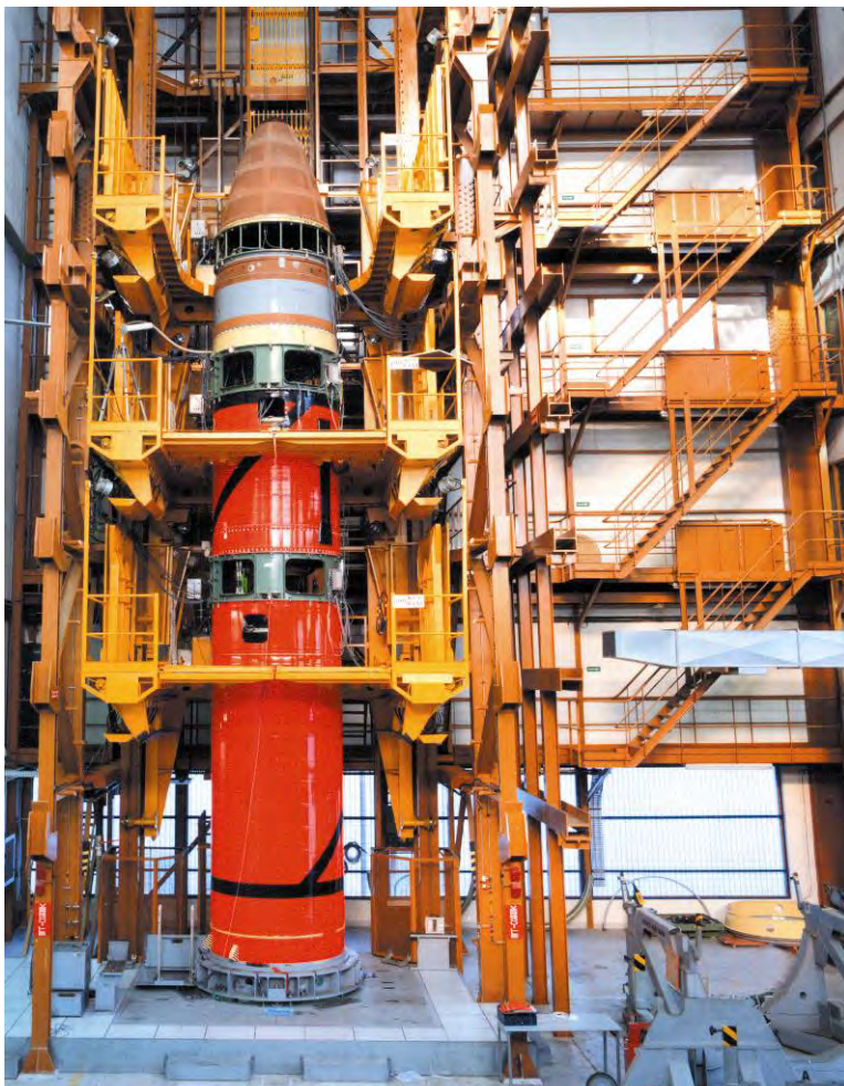
Fig. 14 1980, contrôle par l'Aérospatiale d'un missile expérimental du programme M4 avant envoi par sous-ensembles séparés au CEL pour un essai en vol
