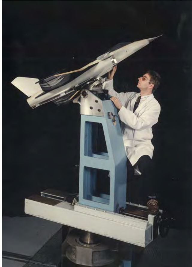
Fig. 73 Contrôle d'une maquette de Rafale dans le laboratoire de qualification de maquettes de l'IMFL.
