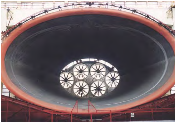
Entrée du diffuseur 16 m x 8 m
