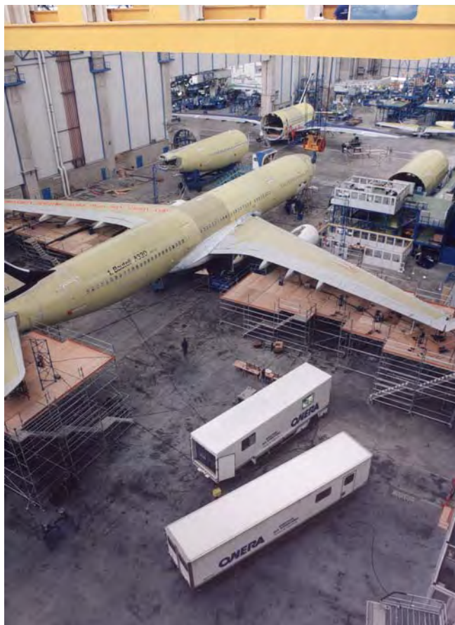
Fig. 79 Essai de vibration au sol de l'A330
