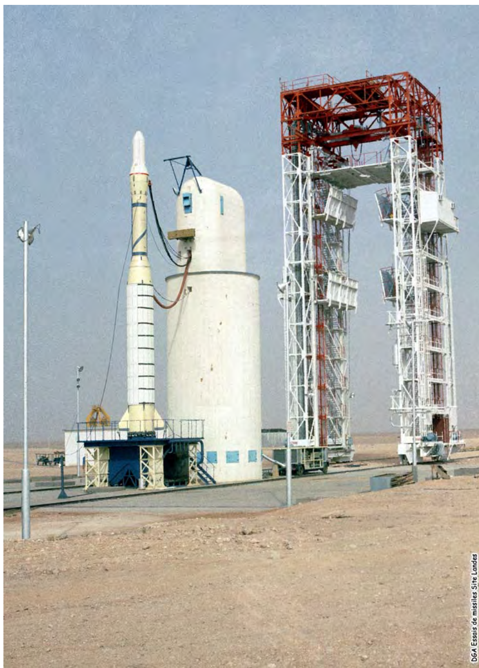
Fig. 28 Véhicule d'essai Saphir à partir duquel devait être dérivé le lanceur de satellite Diamant
