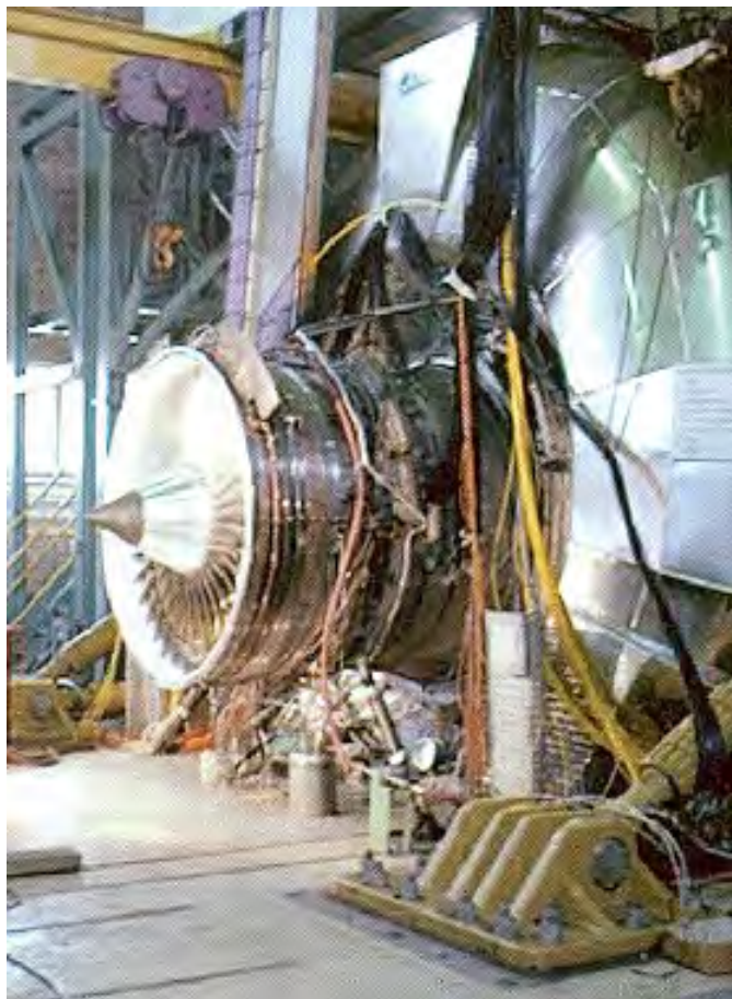
Fig. 28 Compresseur du CFM56 en cours de montage au banc C3
