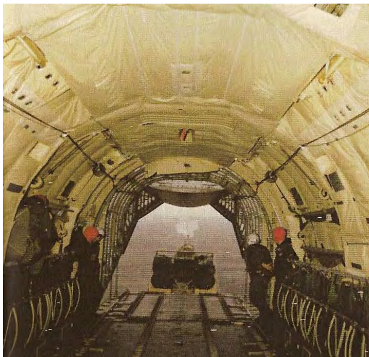
(a) Sortie d'une charge constituée de deux véhicules Lohr 500
