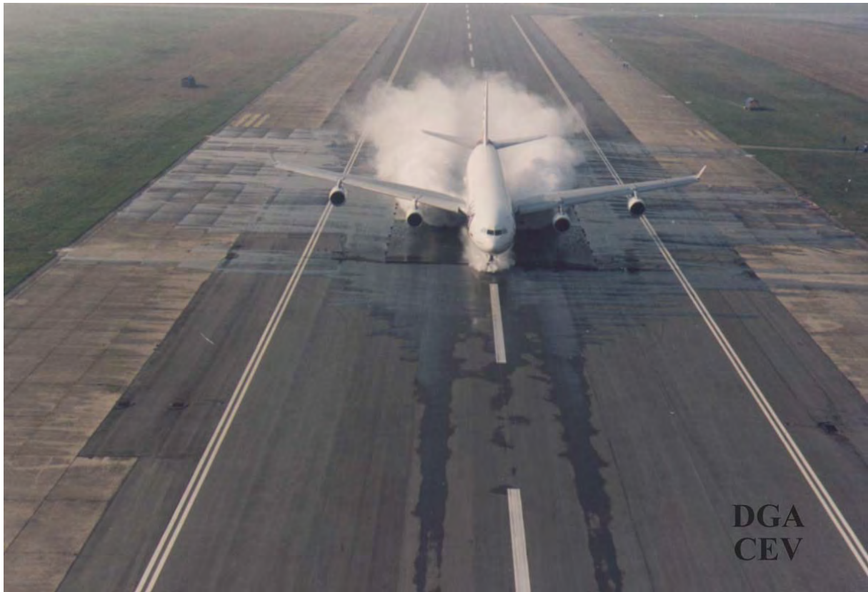
Fig. 7 Essai sur piste inondée
