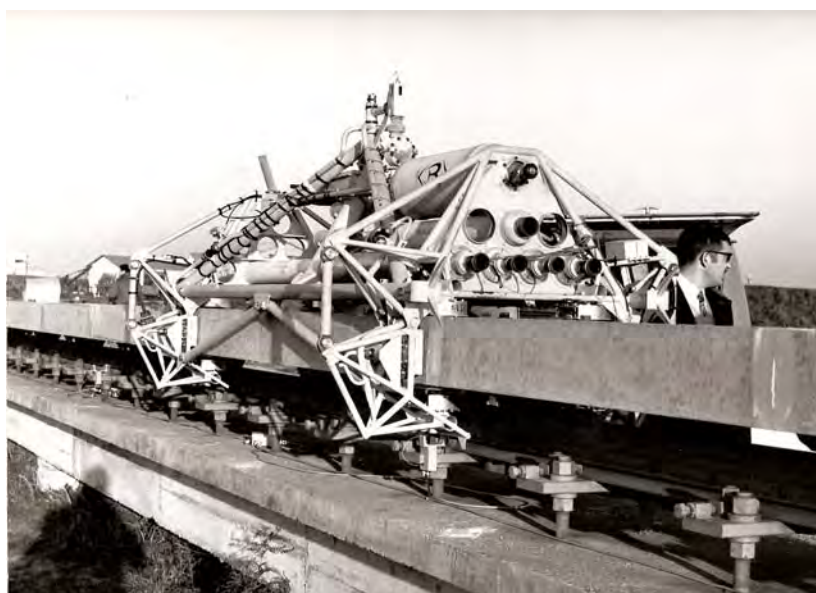
Fig. 27 Véhicule sur coussin d'air
