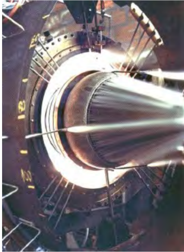
Fig. 15 Chambre de combustion en essais
