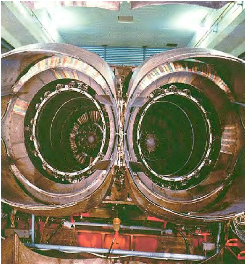
Fig. 20 Deux Olympus 593B en essais simultanés au banc T1
