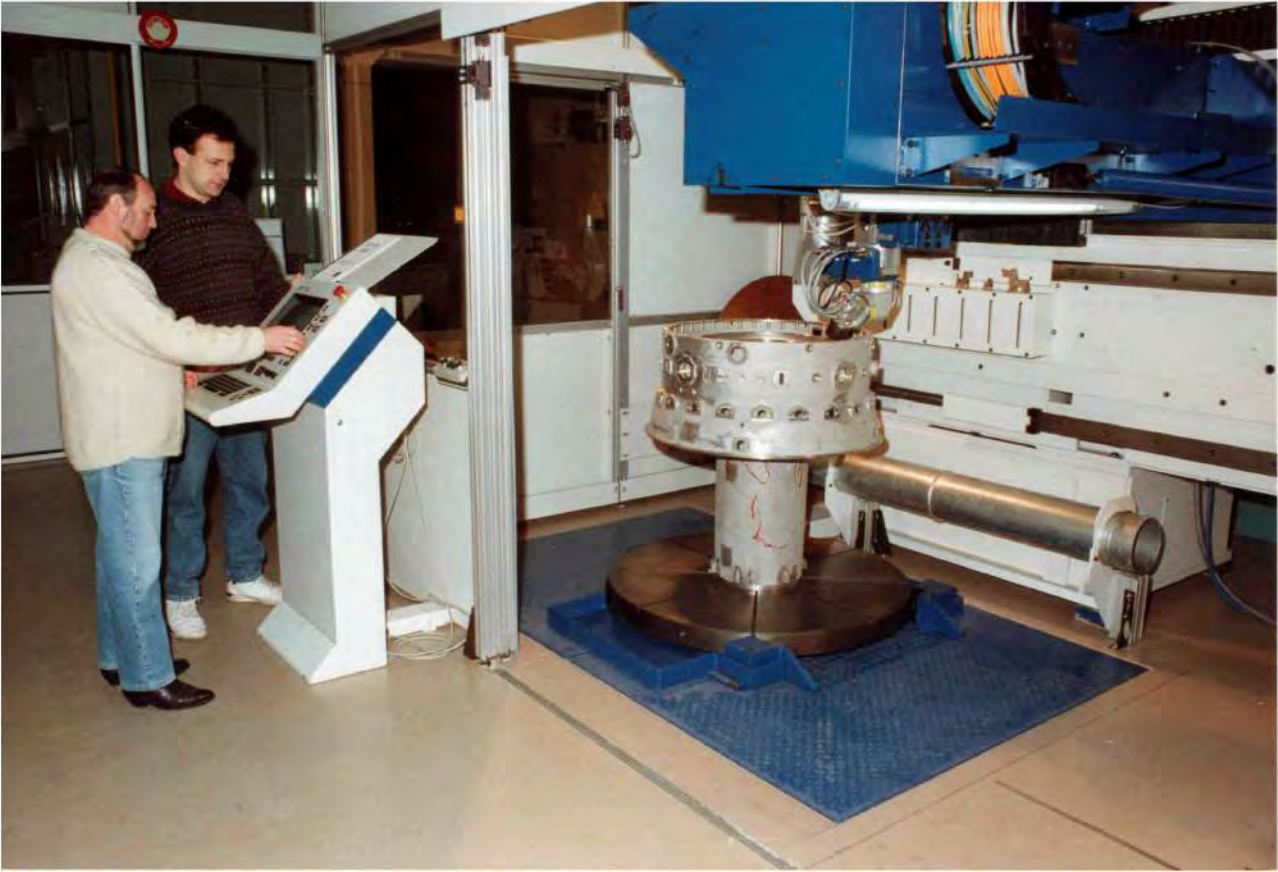
Installation de découpe laser
