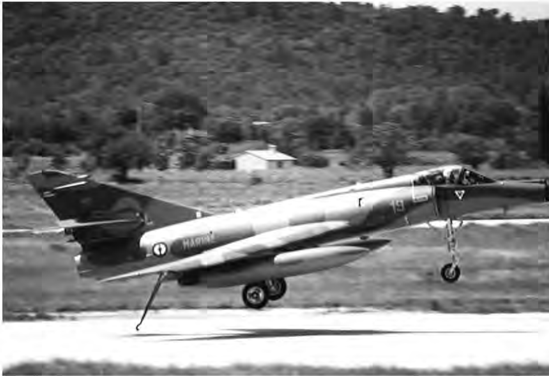
Super Etendard en configuration appontage : crosse, volets et becs de bord d'attaque sortis
