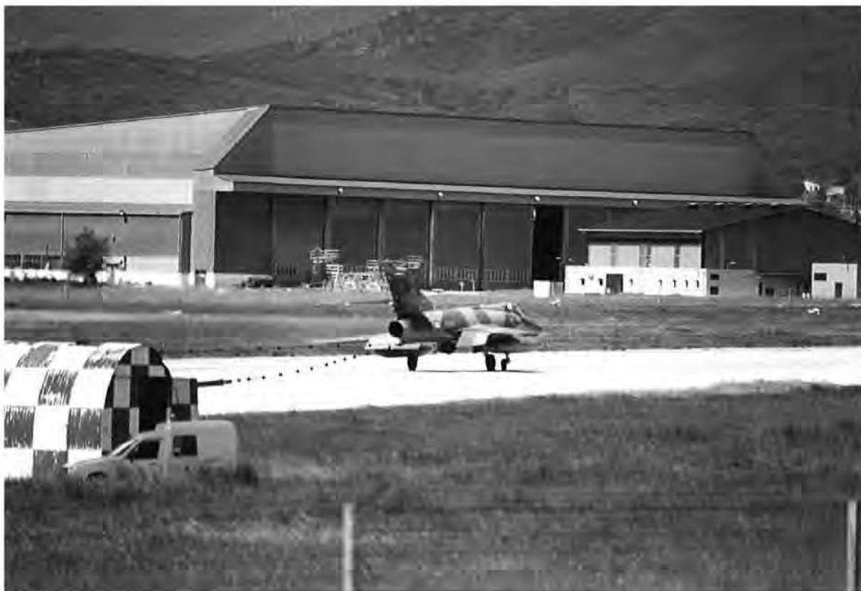
Atterrissage, avec prise de brin, d'un Super Étendard en sortie d'IREF, lors d'un ASSP (appointage simulé sur piste)
