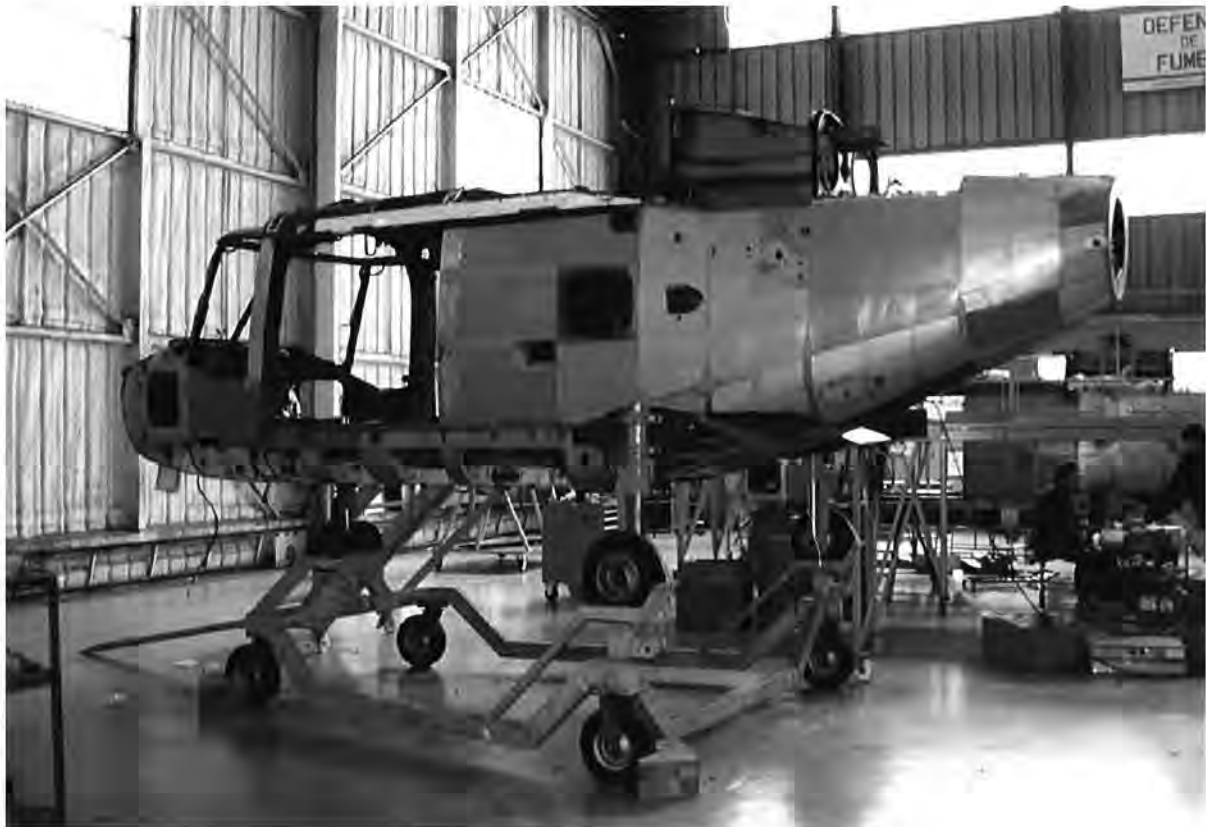
Hélicoptère Lynx sur un chariot de décapage peinture imaginé par les personnels de la chaîne en 1994
