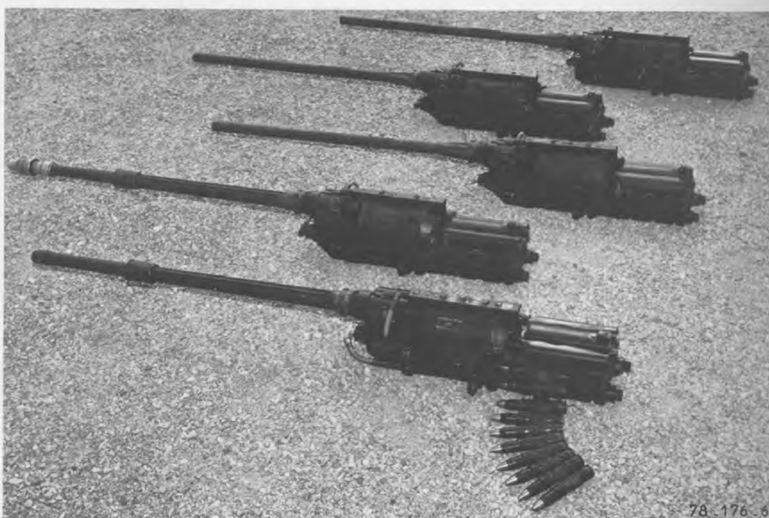
De haut en bas : MAT 551, MAT 552 (Mirage III, Etendard), MAT 552 A (Super Étendard, Mirage III), MAT 553 (Jaguar, F 1, Alpha Jet), MAT 554 (Mirage 2000)
