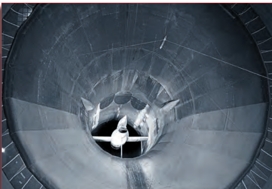
Le Griffon dans la veine de la soufflerie S1 de l'ONERA (8 mètres de diamètre) au site de Modane. Un essai de contrôle global est réalisé sur le fuselage.
