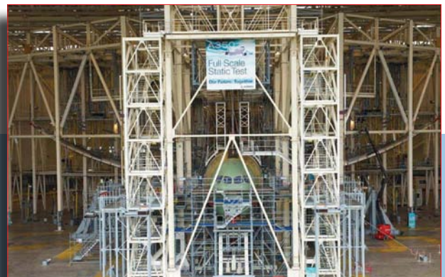
Essai statique de l'aile de l'A350 sous tension proche de la charge extrême A350 Static Test with wing strained close to ultimate load ©Airbus
