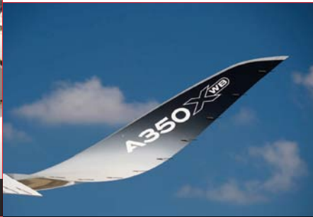
L'ailette courbée de l'A350 qui réduit la traînée A350 drag reducing upswept wingtip © Airbus
